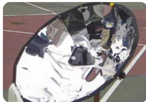
▲太陽熱で調理を行うパラボラ型ソーラークッカーのイメージ
