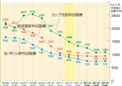
飲料自動販売機出荷数1台あたりの年間消費電力量 (kw・h)
