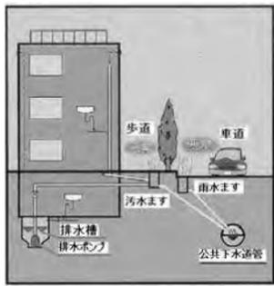
▲ビルの地下にある排水槽で汚水が腐敗すると、臭が発生します
