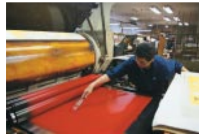
▲コロタイプ印刷 インキ出し作業の様子(写真提供=便利堂)
