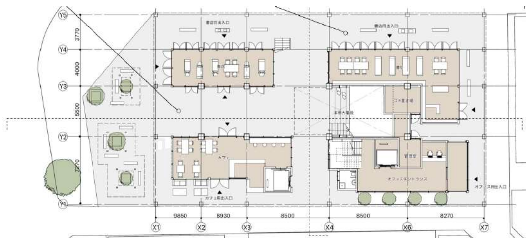
図 21 神保町交差点に面した街区の共同建て替えのモデルスタディの1階平面図
