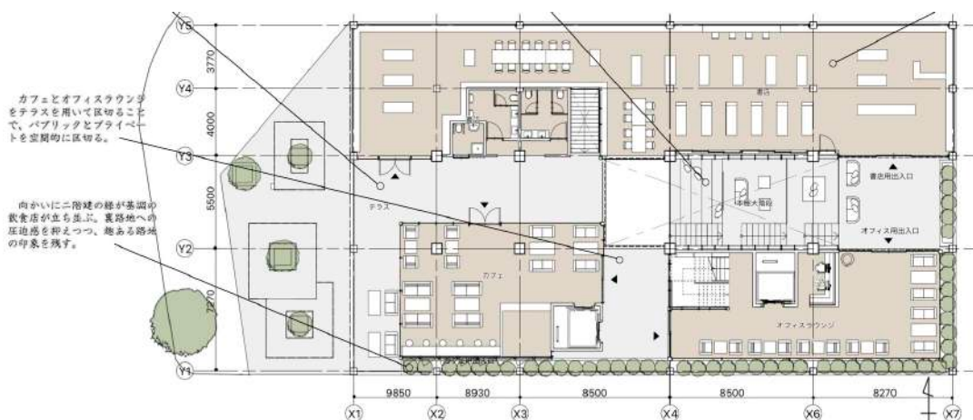
図 23 神保町交差点に面した街区の共同建て替えのモデルスタディの2階平面図
