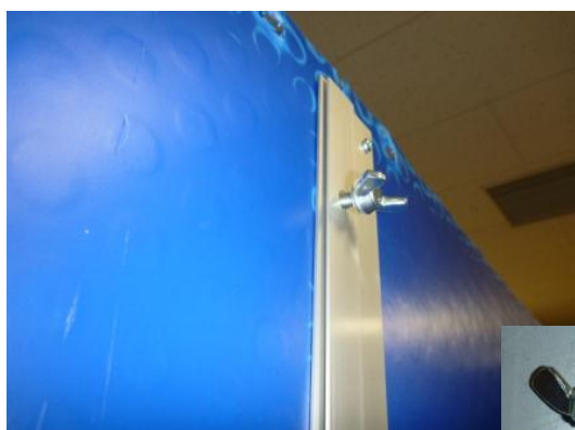
※合わさった部分を 内側からネジでとめる。 (左右3箇所ずつ 計6箇所)
