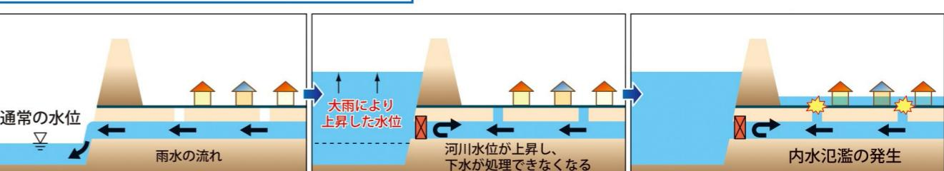
平時は排水先の河川水位が低いので、雨は下水道(雨水管)を通して排水が行われます。
