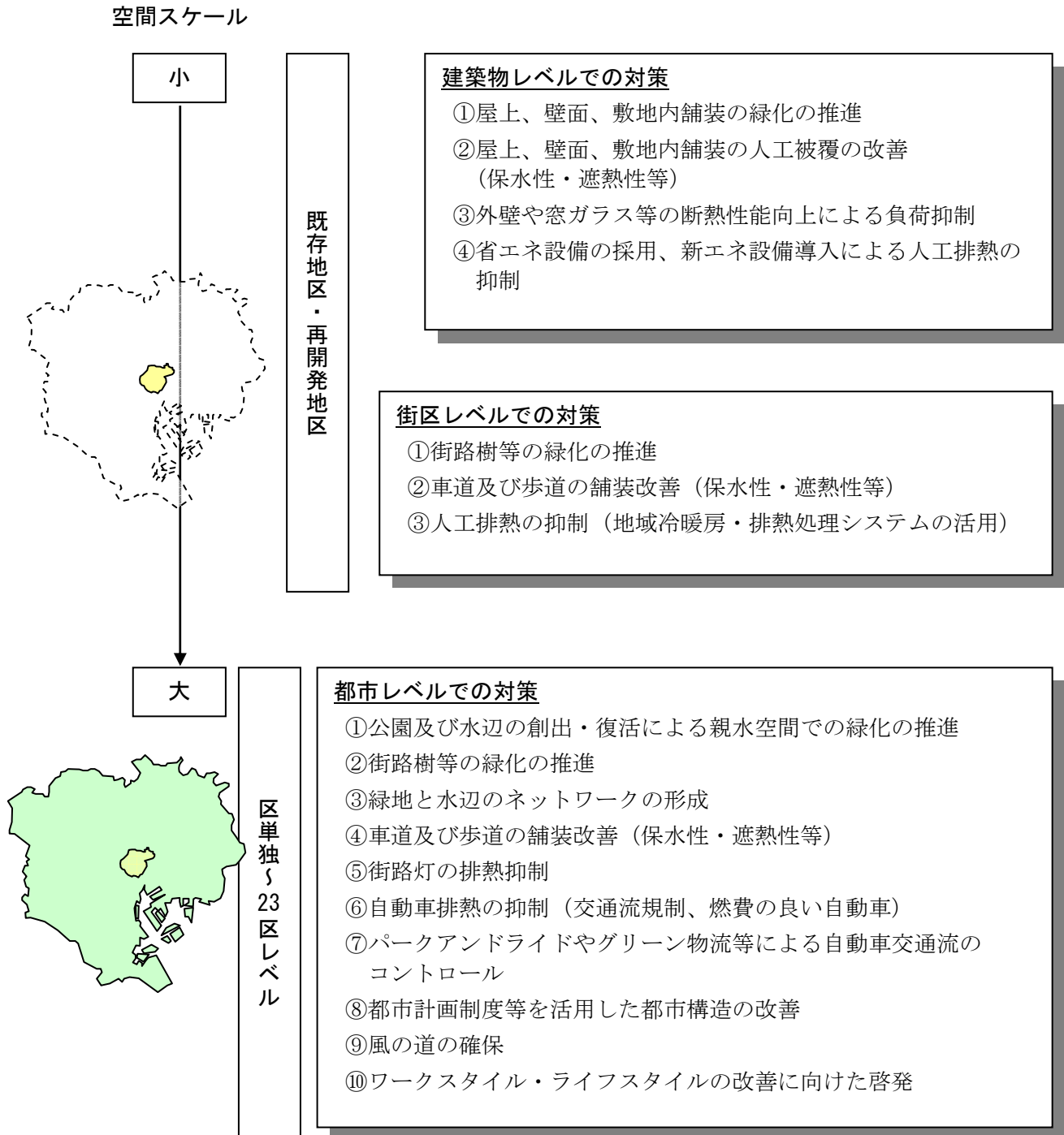
図 千代田区における空間スケール別ヒートアイランド対策
