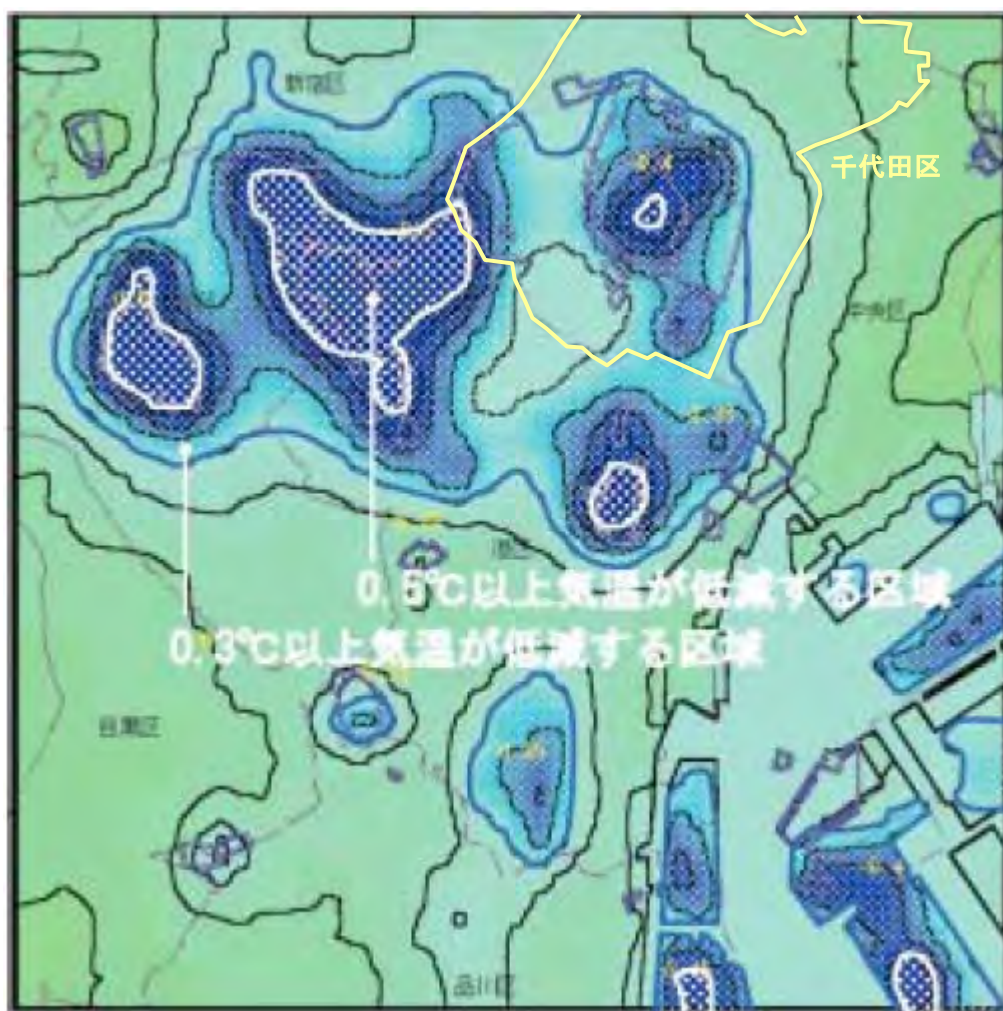
図 現況の気温分布と緑地保全・緑化施策を総合的に講じた場合のシミュレーション結果の気温差
