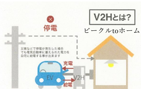
停電時などにEVから家に給電できる。
