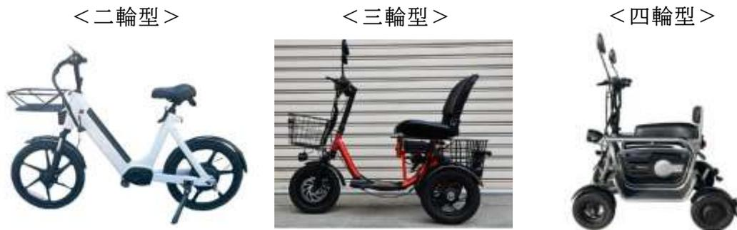
図 2-59 二輪、三輪、四輪型の特定小型原動機付自転車
