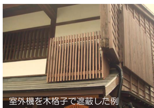
室外機の設置位置の工夫により歴史的な街並みを守っている例
