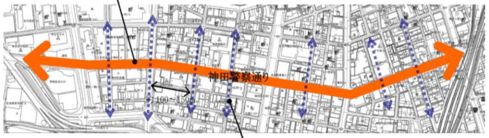
神田警察通りの整備イメージ 現況: 4車線一方通行・駐車レーン、歩道幅員 2.7～3.5m (有効 1.3～2.2m) ※道路断面構成などの計画は確定したものではありません
